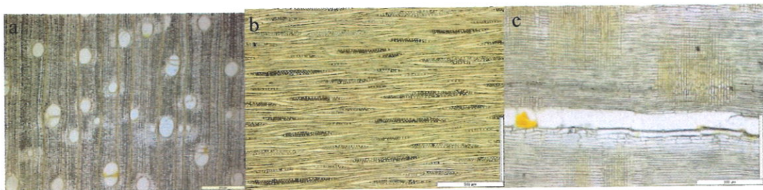
Photo 4. Coupe anatomique du bois de P. balsamifera : a. coupe transversale, b. coupe tangentielle, c. coupe radiale
